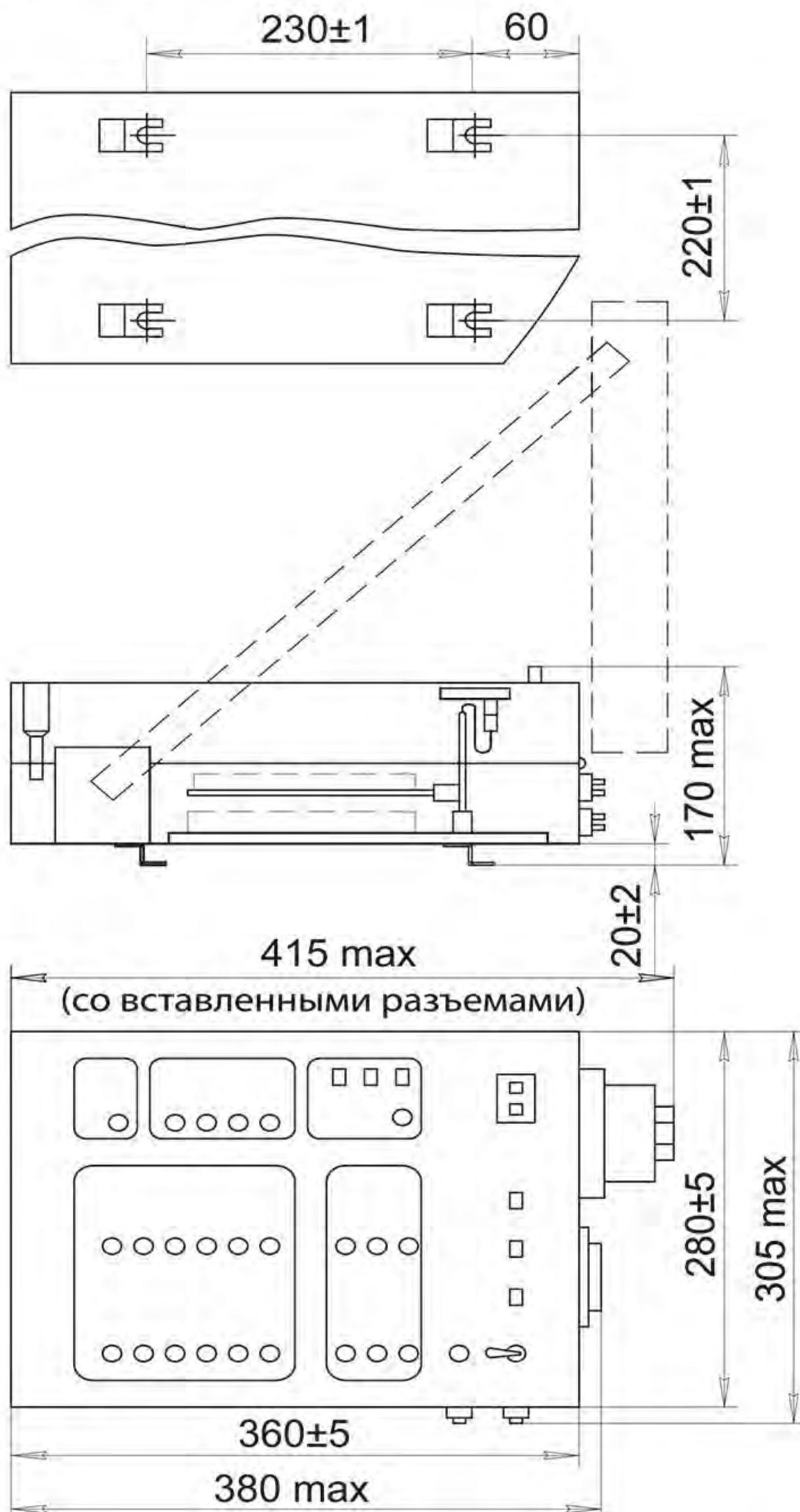
Габаритные и установочные размеры блоков БКЭ7М, БКЭ1, БКЭ2
