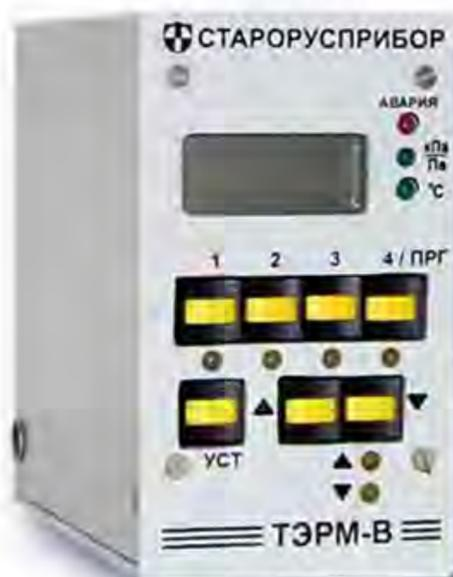
**Регулятор ТЕРМ** представляет собой специализированный регулятор, совмещающий в себе функции трех регуляторов: производительности, соотношения топливо/воздух и разрежения. Дополнительно регулятор обеспечивает некоторые функции измерения и контроля параметров, а также обеспечивает некоторые функции, связанные с технологическим процессом работы теплоагрегатов.
