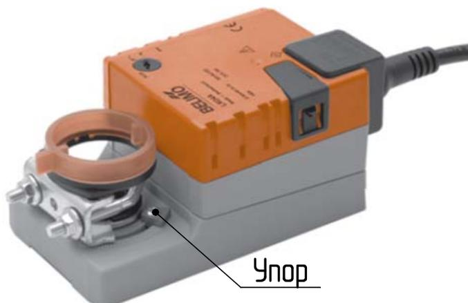
Настройка крайних положений газовой и воздушных заслонок производится путём изменения местоположения упоров сервопривода. Настройка выключателя для контроля закрытого положения газовой заслонки производится путем установки кулачка привода микровыключателя таким образом, чтобы контакты S1, S2 находились в замкнутом со-
