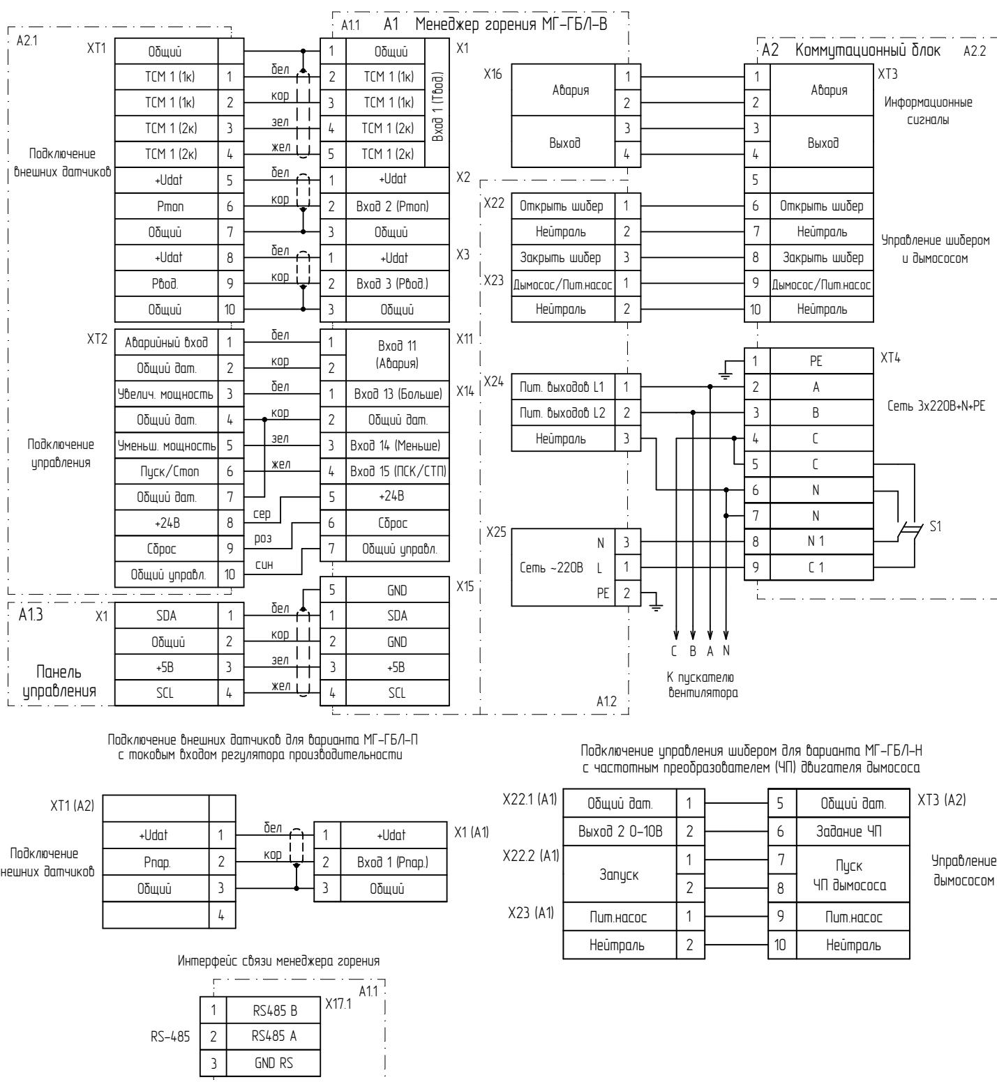
Рисунок Е.1. Схема электрическая принципиальная горелки
