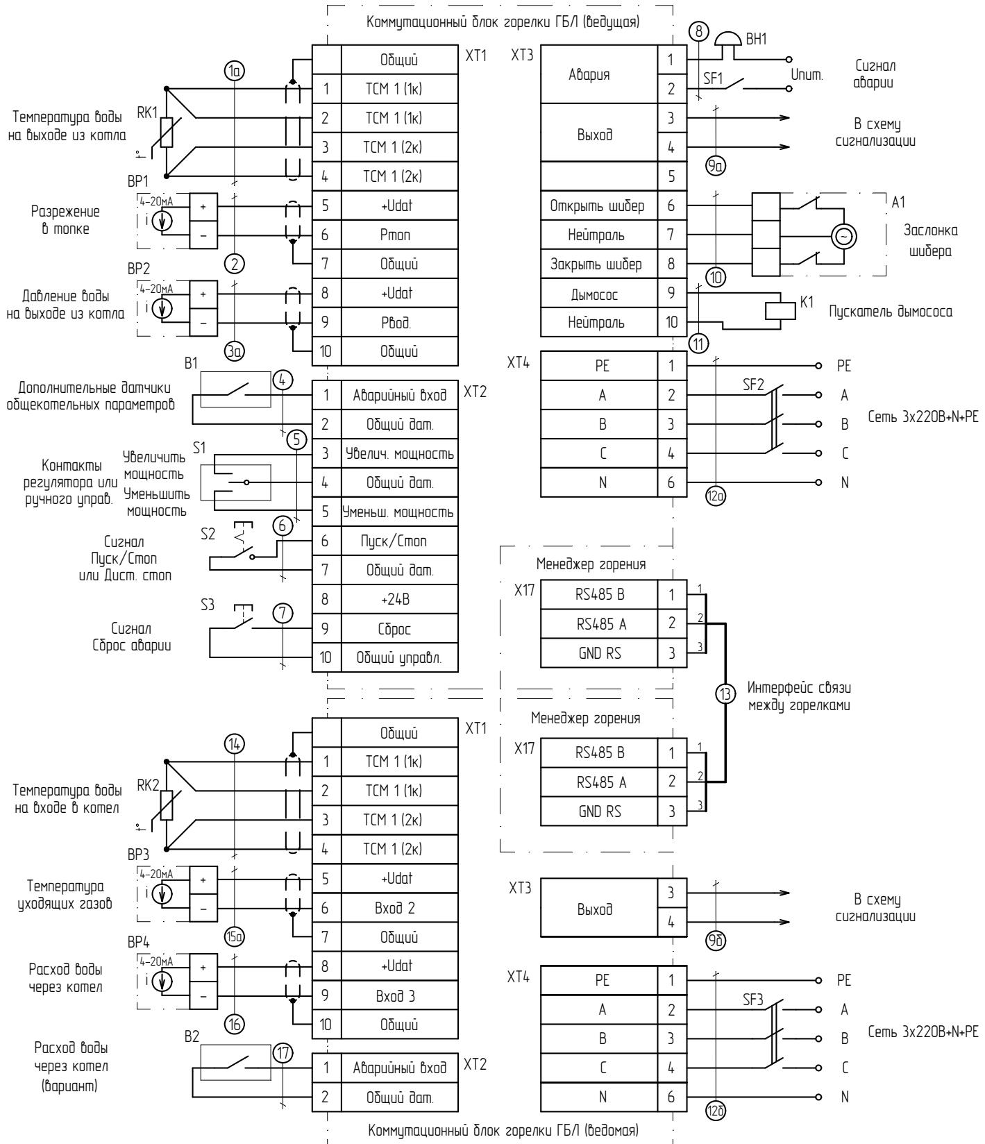
**Рис. Л.1 Схема подключений двухгорелочного котла типа ДКВР
