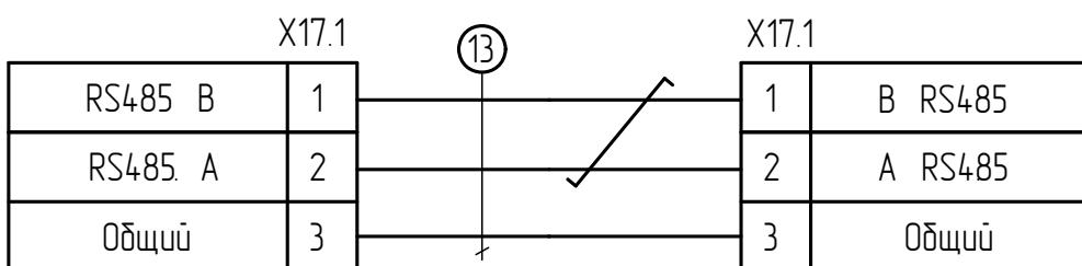
Рис.Ж.2 Схема соединений линий интерфейса
