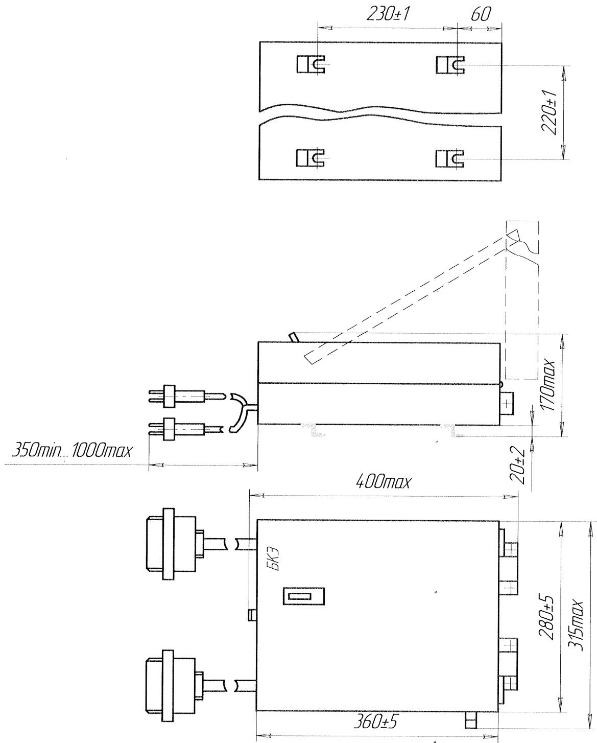
Рис. П.2 Габаритные и установочные размеры блоков БКЭ7М, БКЭ1 и БКЭ2
