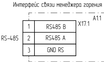
Рисунок Е.1. Схема электрическая принципиальная горелки (соединения с коммутационным блоком)
