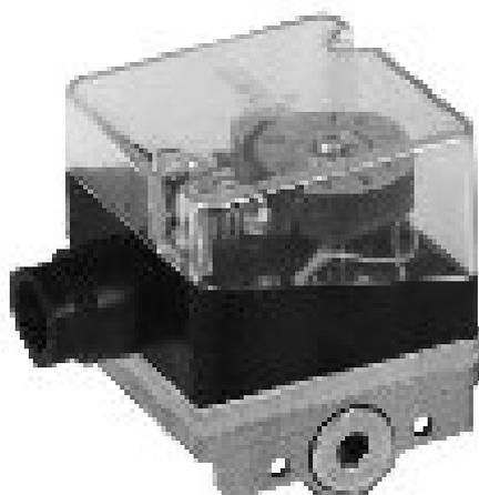
Датчики-реле давления газа служат для контроля минимального/максимального давления газа на входе в арматурную группу горелки и для автоматической проверки герметичности газовых клапанов. Датчик-реле, предназначенный для контроля минимального давления газа, размыкает электрическую цепь при уменьшении фактического значения давления газа на входе по отношению к установленному заданному значению. Датчик-реле, предназначенный для контроля максимального давления газа, размыкает электрическую цепь при
