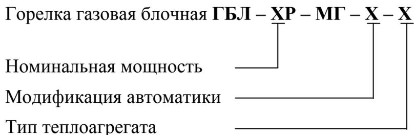
Расшифровка условного обозначения горелки.
