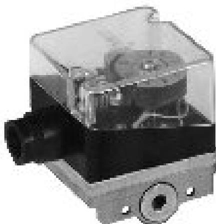
Датчики-реле давления газа служат для контроля минимального/максимального давления газа на входе в арматурную группу горелки и для автоматической проверки герметичности газовых клапанов. Датчик-реле, предназначенный для контроля минимального давления газа, размыкает электрическую цепь при уменьшении фактического значения давления газа на входе по отношению к установленному заданному значению. Датчик-реле, предназначенный для контроля максимального давления газа, раз-
