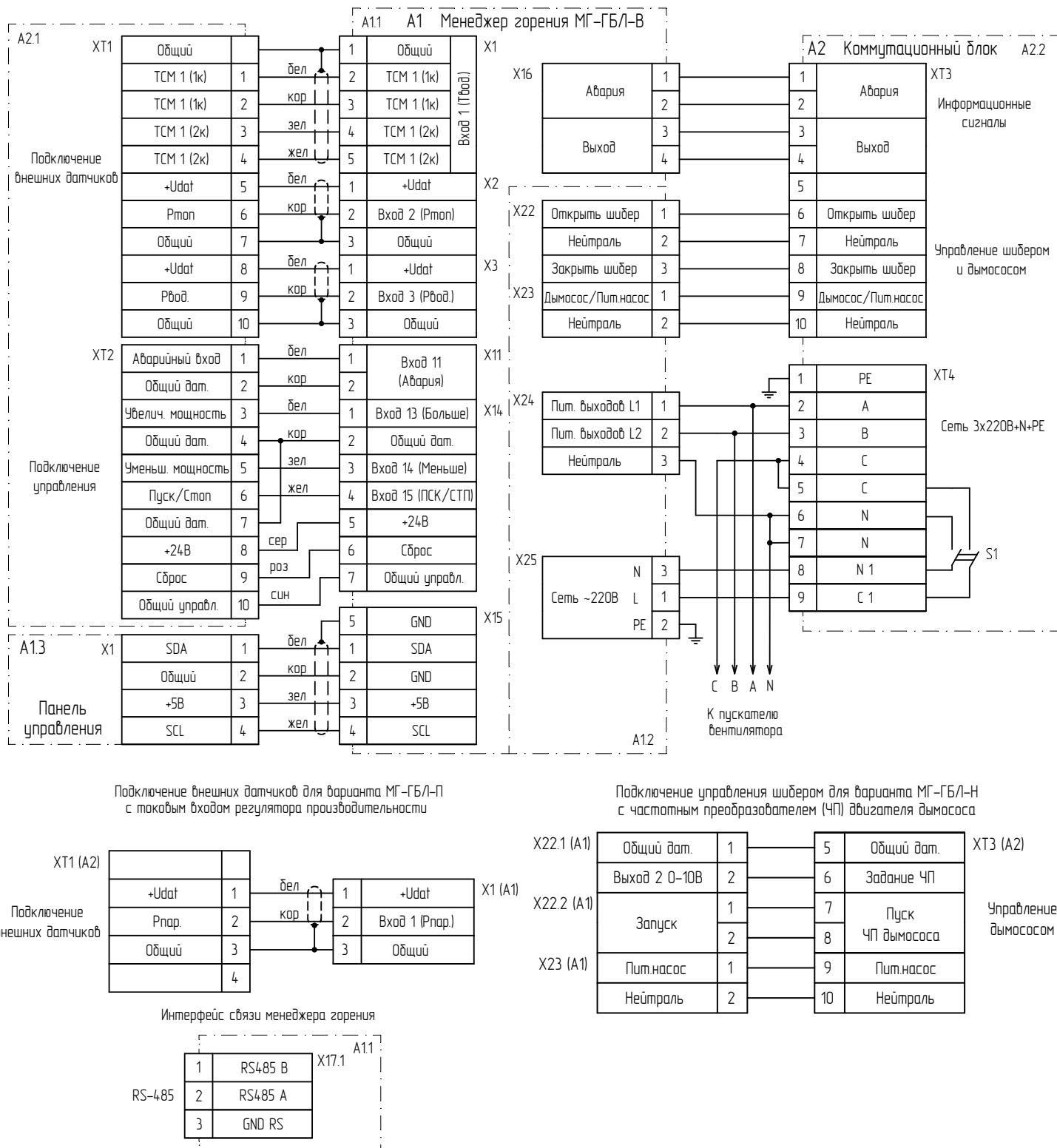
Рисунок Е.1. Схема электрическая принципиальная горелки
