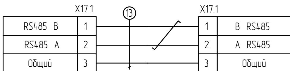
X17.1 Клеммник на кабель ЕС350V-03Р
