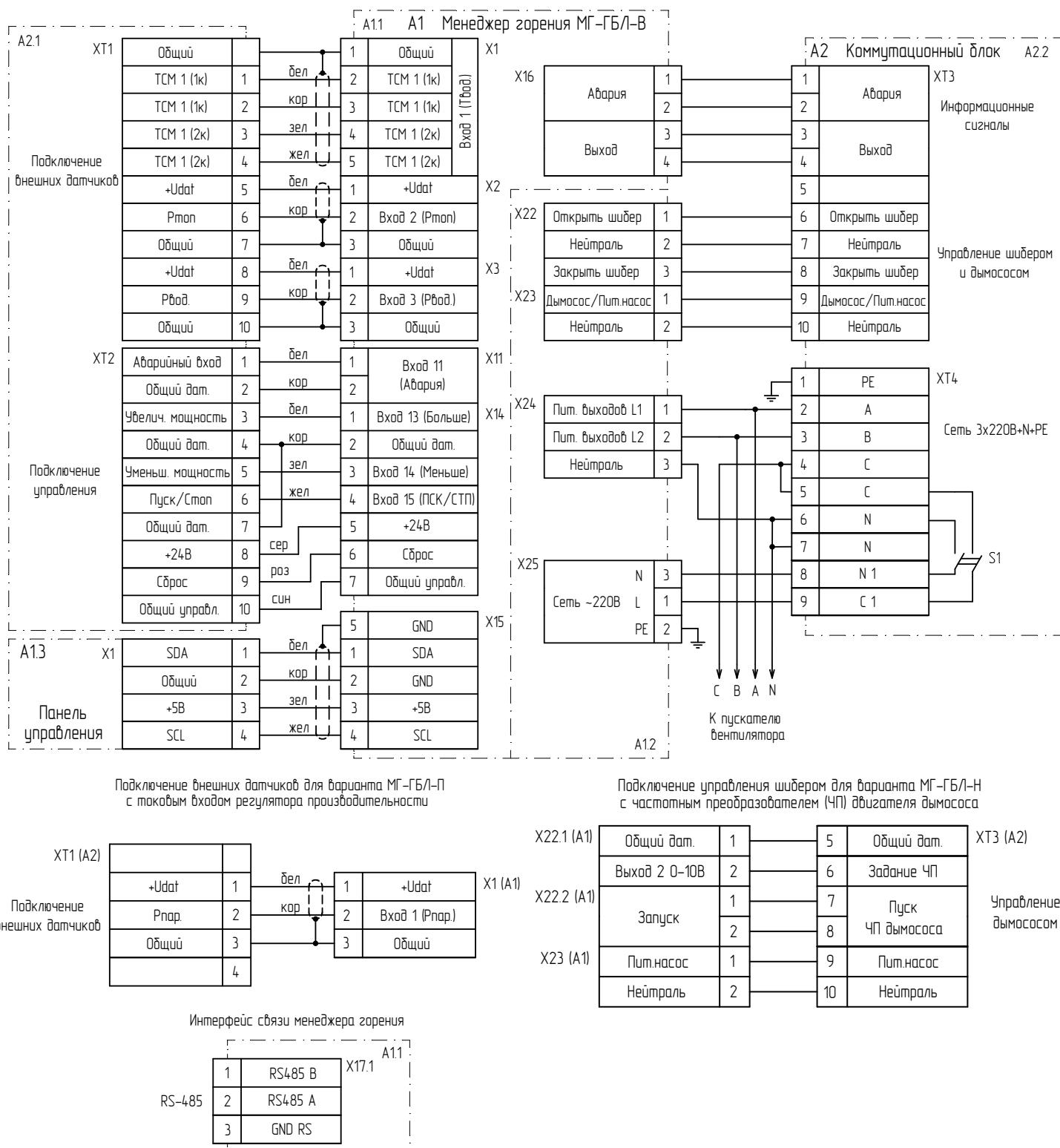
Рисунок Е.1. Схема электрическая принципиальная горелки
