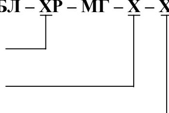
Расшифровка условного обозначения горелки.
