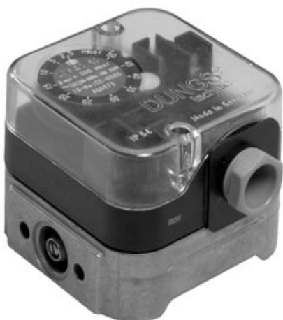
Датчик-реле давления воздуха служит для контроля наличия давления воздуха в горелке (контроля работы вентилятора). Датчик-реле размыкает электрическую цепь при уменьшении фактического значения давления воздуха по отношению к установленному заданному значению, в случае частичной или полной неработоспособности вентилятора, или в случае попадания в воздушный тракт горелки посторонних предметов, препятствующих нормальной работе вентилятора.
