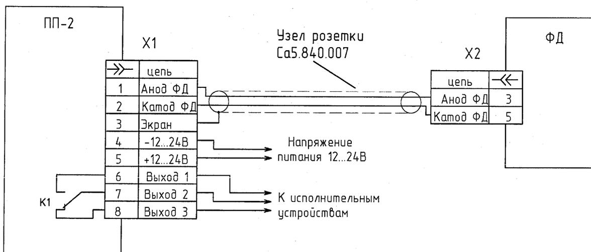
X1 - разъемный клеммник 2EDGK-5.08-08P-14-00A
